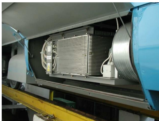
Статический преобразователь с двигатель - вентилятором
